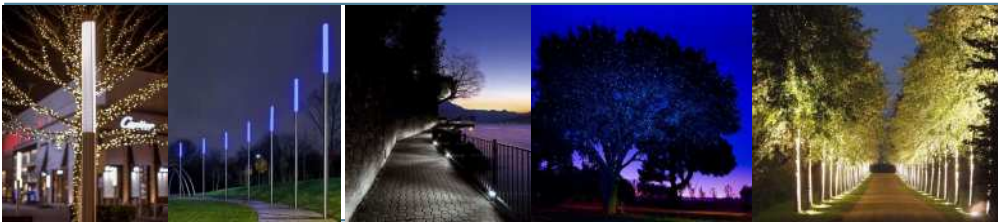
연직면 조도 확보를 통한 인지성 부여 스텝조명으로 광원의 노출을 최소화 하고 수목을 이용하여 장식적 연출을 권장
