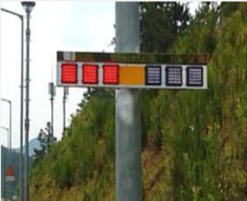
갓길 설치(가로등 충전식)
