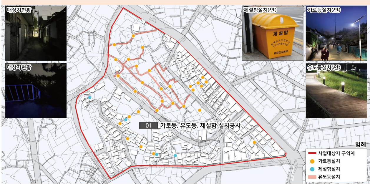
[그림] 가로등, 유도등, 제설함 설치 계획도
