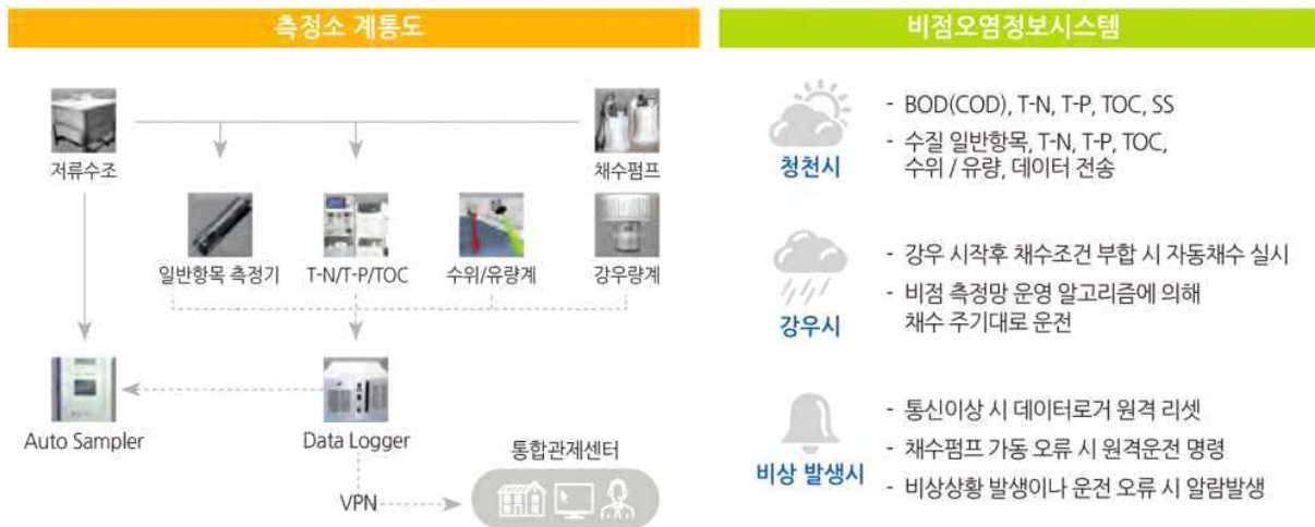
(그림5-3) 비점오염저감시설 원격 제어 및 모니터링 시스템 사례
