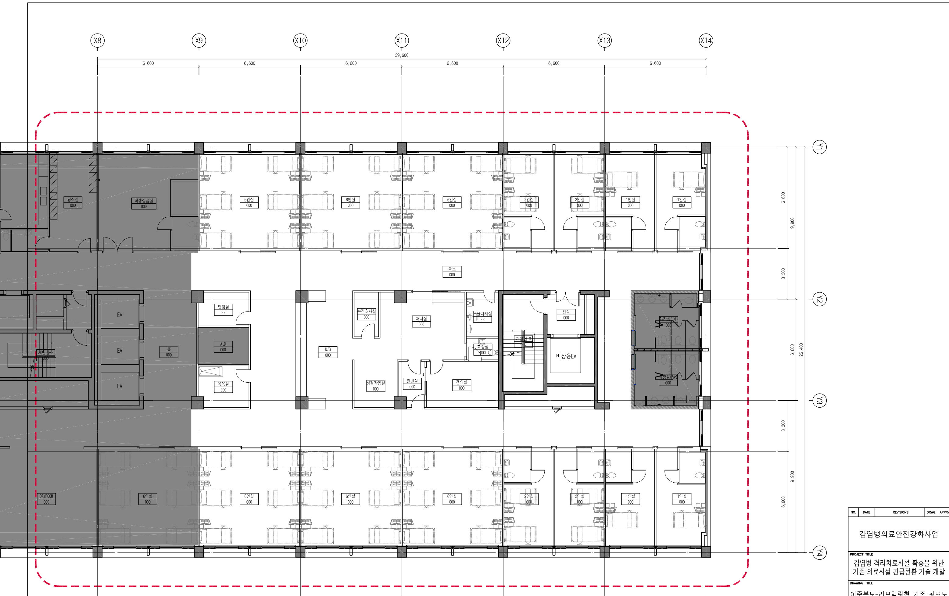
1 이중복도-리모델링형 기존평면도 축척 A1 : 1/75 A3 : 1/150
